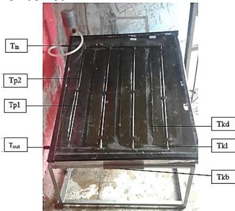
Gambar 1. Titik-titik pengukuran pada kolektor surya
