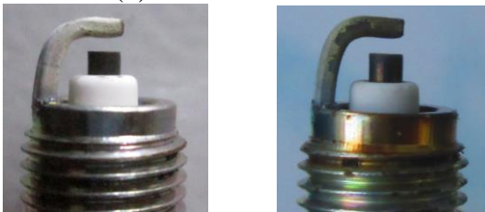
a. Busi Pertamina b. Busi Premium Gambar 1. Busi baru sesaat setelah digunakan
