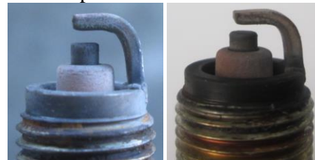
a. Busi Pertamina b. Busi Premium Gambar 5. Busi setelah digunakan 4000 km
