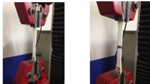
Gambar 6. *Polymer ABS* sebelum dan setelah proses pengujian
