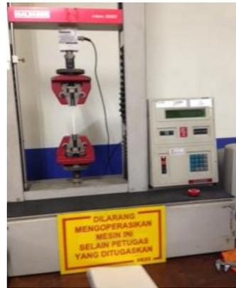
Gambar 5. Mesin pengujian tarik
