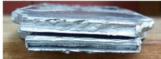
Gambar 6. Foto makro patahan spesimen dengan sambungan FSW
