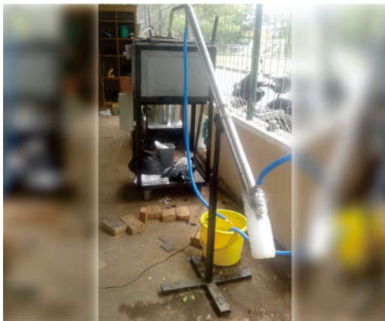
Gambar 4. Hasil manufaktur pyrolyzer
