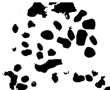
Gambar 4. Partikel es setelah di-threshold
