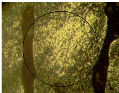
Gambar 3. data pengujian metalografi material komposit Alumunium – abu dasar batubara dengan quenching oli SAE 10-40 dan waktu tahan aging 1 jam pembesaran 200x
