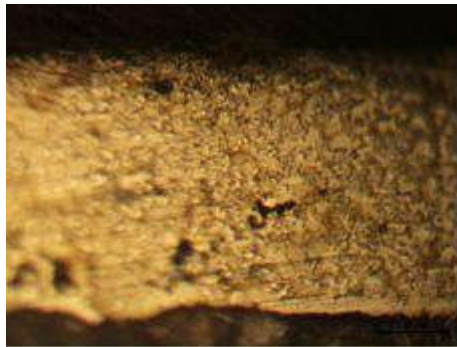
Gambar 3. Ketebalan lapisan Ni-W
