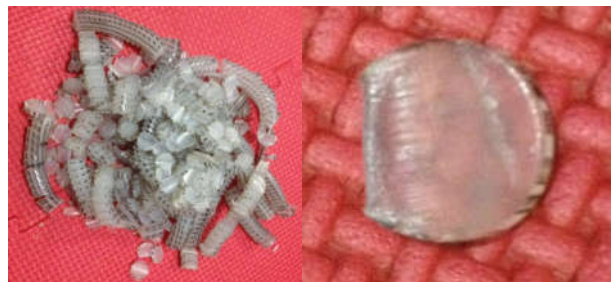
Gambar 16. Produk hasil pemotongan pisau tipe chisel.
