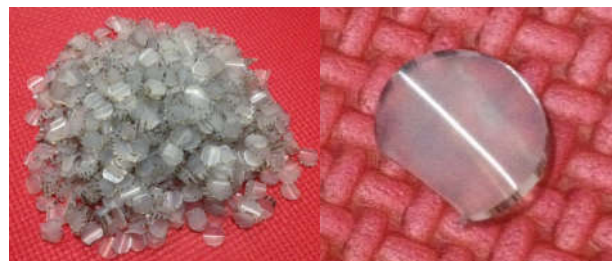
Gambar 15. Produk hasil pemotongan pisau tipe V (flat) ground.
