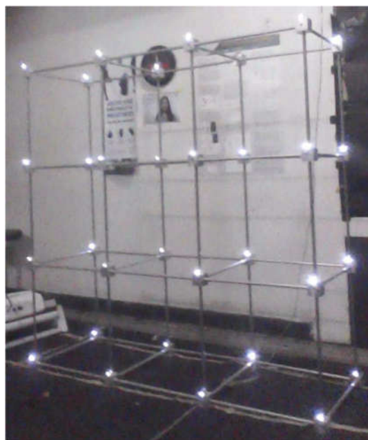
Gambar 6. Hasil kerangka kalibrasi menggunakan rancangan dalam penelitian ini
