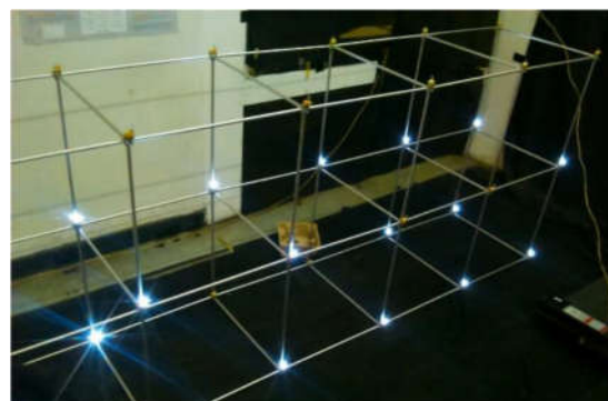
Gambar 1. Kerangka kalibrasi pada sistem analisis gerak sebelumnya
