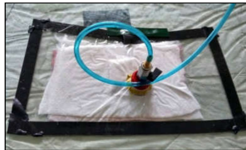
Gambar 8. Laminasi setelah divakum
