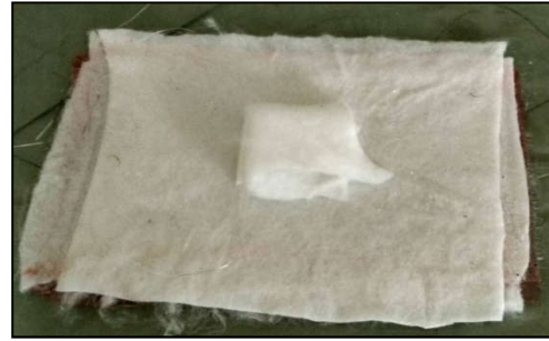
Gambar 7. Penambahan breather untuk bagian port
