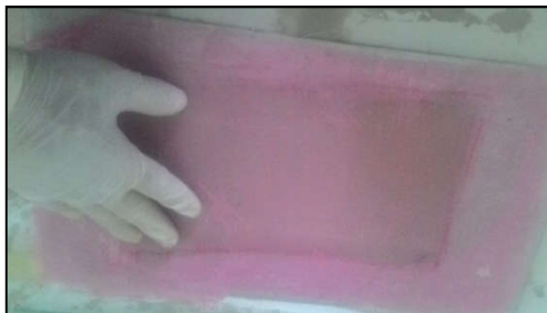
Gambar 5. Peletakan release film
