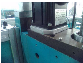
Gambar 12. Penambahan Flange Sebagai Dudukan Motor Baru
