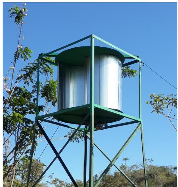
**Gambar 2** Konstruksi Turbin Savonius
