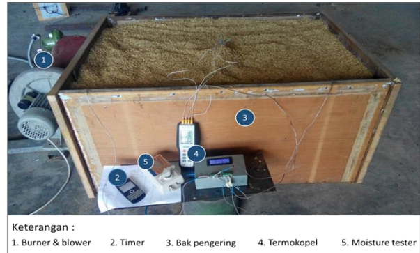
Gambar 5. Instalasi peralatan pengujian pengeringan gabah
