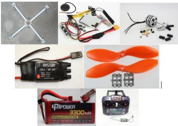
Gambar 3. Komponen-komponen *quadcopter*
