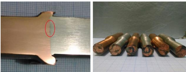
Gambar 3. Foto potongan dan patahan dari spesimen dengan waktu gesek 15 detik
