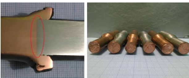
Gambar 4. Foto potongan dan patahan dari spesimen dengan waktu gesek 30 detik
