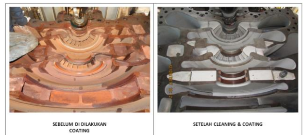
Gambar 8. Coating Casing Bagian Dalam Rotor
