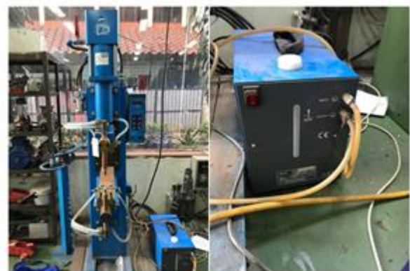
Gambar 2. Skema mesin pengelasan \mu FSSW
