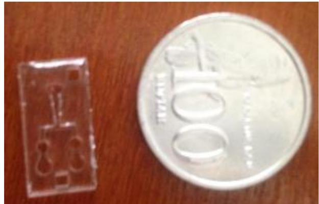
**Gambar 18. PDMS Micro-channel**
