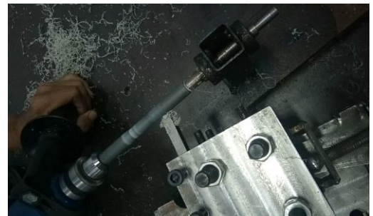
Gambar 10. Posisi pemegang pahat dalam uji coba menggunakan penggerak bor manual
