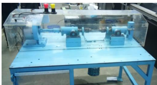
Gambar 7. Letak konstruksi pemegang pahat berada di depan spesimen pada landasan meja mesin
