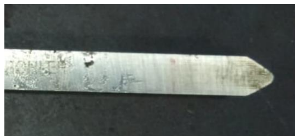
Gambar 16. Radius pahat sekitar 1,2 mm yang berhasil membubut spesimen standar uji lelah
