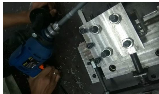
Gambar 9. Posisi pemegang pahat dalam uji coba menggunakan penggerak bor manual
