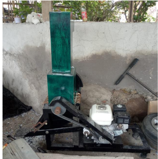
Gambar 3 Mesin pencacah plastik hasil modifikasi (4)
