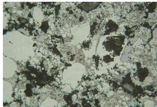
Gambar 16. Struktur mikro logam komposit matriks paduan Al-Si (7,14%Si) dengan penambahan 20% SiC.
