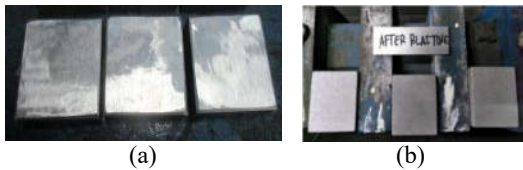
Gambar 10. (a) Benda uji sebelum blasting , (b) Benda uji sesudah blasting .
