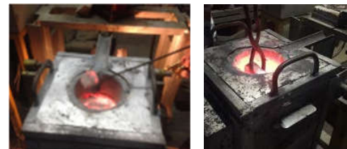
Gambar 3. Pembuangan kotoran dan pencampuran bahan paduan magnesium, silikon, dan seng.
