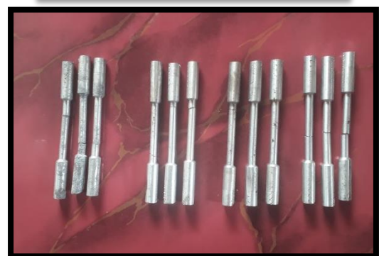
Gambar 3.(a)specimen uji tarik, (d) specimen uji impak
