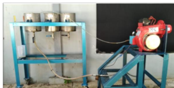
Gambar 3. Rangkaian pengujian biodiesel
