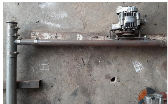
Gambar 11. Pembuatan dudukan alternator turbin
