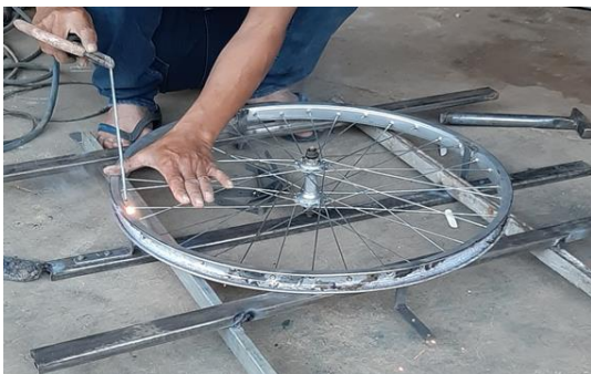
Gambar 7. Pembuatan lengan sudu turbin
