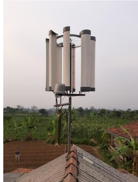
Gambar 15. Pengujian turbin 8 sudu
