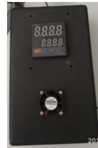
Gambar 6. Display setting point suhu dan panel kontrol
