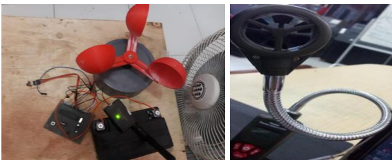
Gambar 5. Pengujian membandingkan dengan anemometer standard
