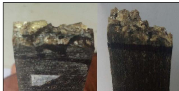
Gambar 5. Bentuk patahan komposit .
