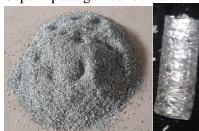
Gambar 1. Aluminium dan magnesium skrap serta hasil proses pemadatan
