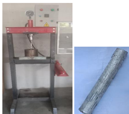
Gambar 2. Alat squeeze casting dan hasil dari proses squeeze casting
