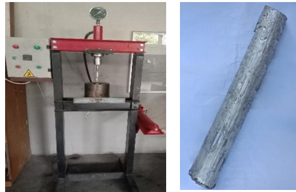
Gambar 2. Alat dan hasil dari proses squeeze casting
