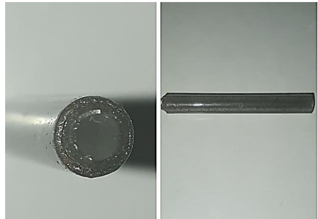
Gambar 2. Tube dengan material komposit (poliester + 2,5% serbuk Fe).
