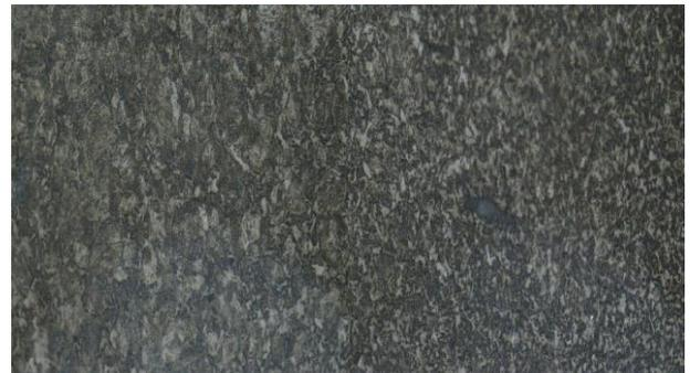
**Gambar 7.** Perubahan ukuran grain pada structural steel
