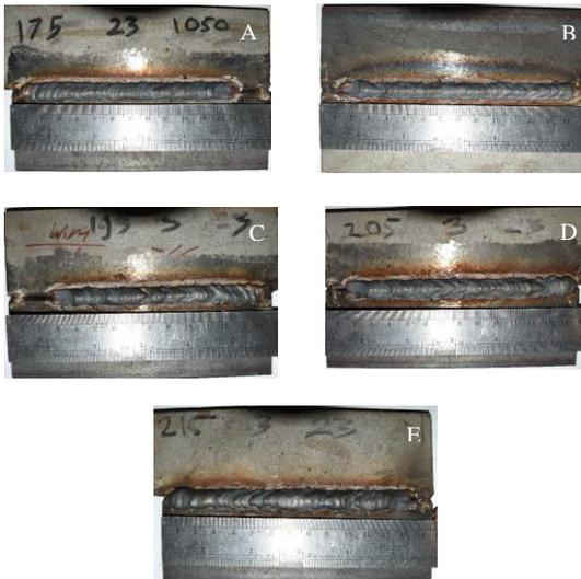
**Gambar 2.** Hasil pengelasan dengan arus pengelasan a) 175A, b) 185A, c) 195A, d) 205A dan e) 215A
