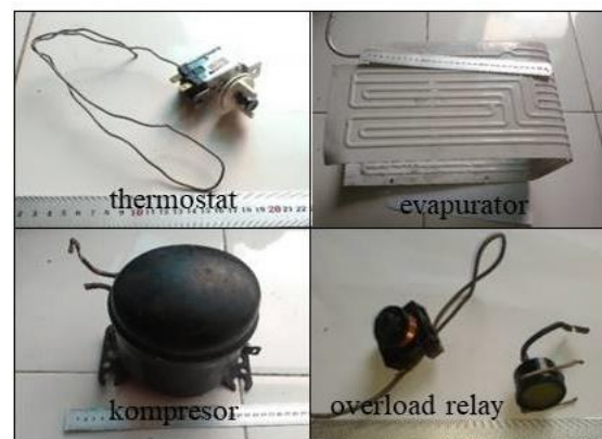
Gambar 5. Beberapa komponen bekas kulkas yang dipakai lagi dalam remanufaktur
