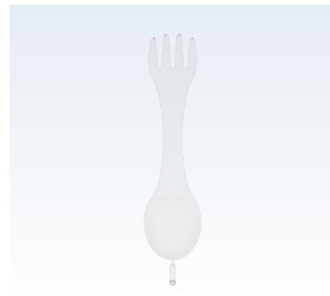
Gambar 3. Cacat *air traps* lokasi *gate* 1
