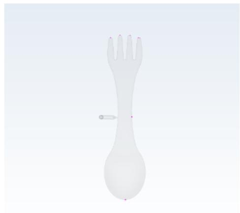
**Gambar 9.** Cacat *air traps* lokasi *gate 3*.
