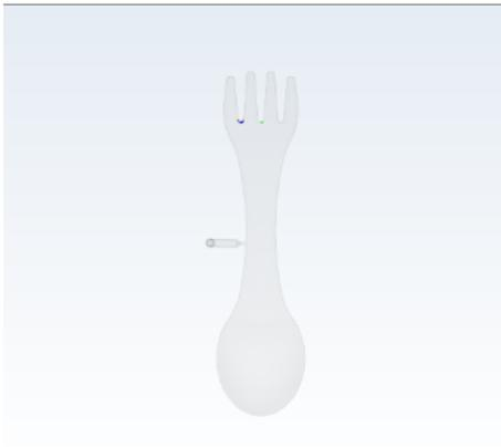
Gambar 10. Cacat weld line lokasi gate 3.
