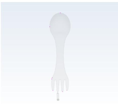
**Gambar 6.** Cacat *air traps* lokasi *gate 2*.
