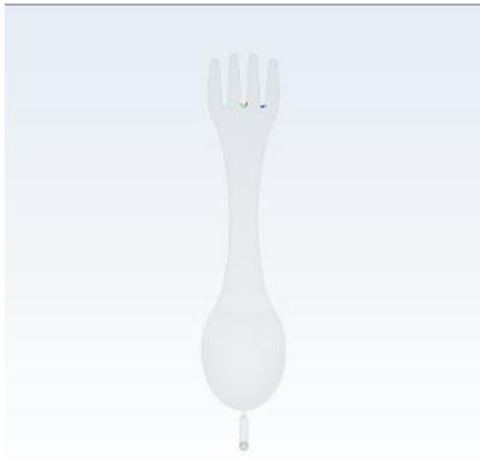
**Gambar 4.** Cacat *weld line* lokasi *gate 1*
