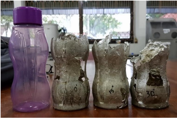
Gambar 4. Hasil pengecoran logam pewter dengan kemiringan 0°, 15°, dan 30°
