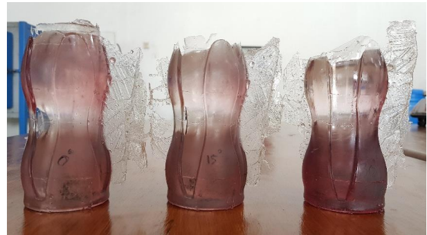
Gambar 5. Hasil pengecoran material resin dengan kemiringan 0°, 15°, dan 30°
