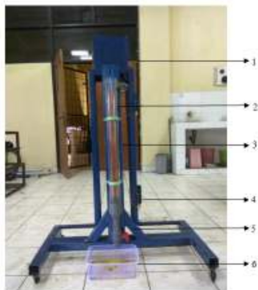
Gambar 2. Hasil rancangan alat uji viskometer sistem bola jatuh
