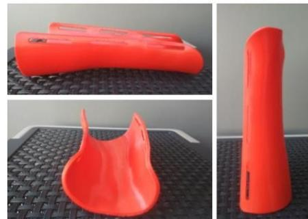
GAMBAR 10. *Brace* hasil cetak *3D print*
