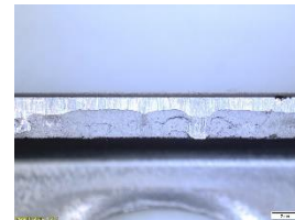
Gambar 9 Hasil Piercing dengan magnification 0,67x
