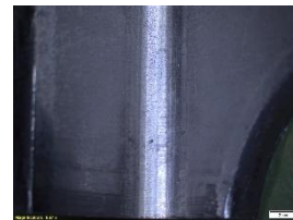
Gambar 7 Area yang terkena Bending dengan magnification 0,67x
