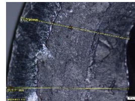
Gambar 8 Hasil Bending dengan magnification 4,5x
