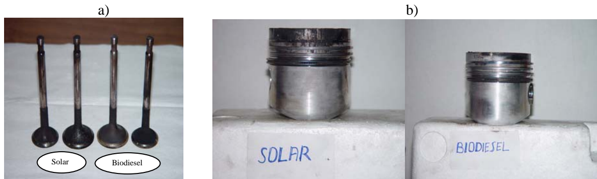
Gambar 3. a) Deposit pada katup tulip, b) Deposit pada land piston
