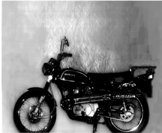
Gambar 3. Visualisasi aliran pada sepeda motor skala penuh [Settles, et al., 1995].
