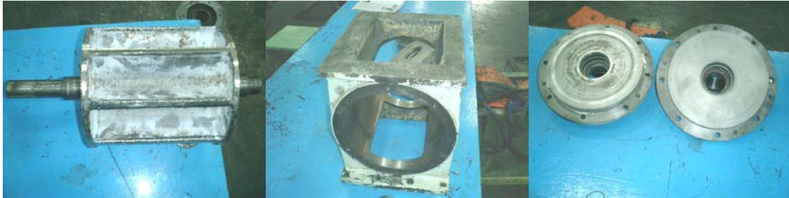
Gambar 1. Bagian Rotor Airlock, housing dan flange yang mengalami keausan
