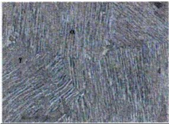
Gambar 3. Struktur mikro kondisi awal paduan Ti-48Al (lokasi B, 50x)
