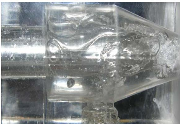
Gambar 10 Pengujian pada tekanan statik kompresor ( $p_c$ ) =  $1 \text{ kg/cm}^2$
