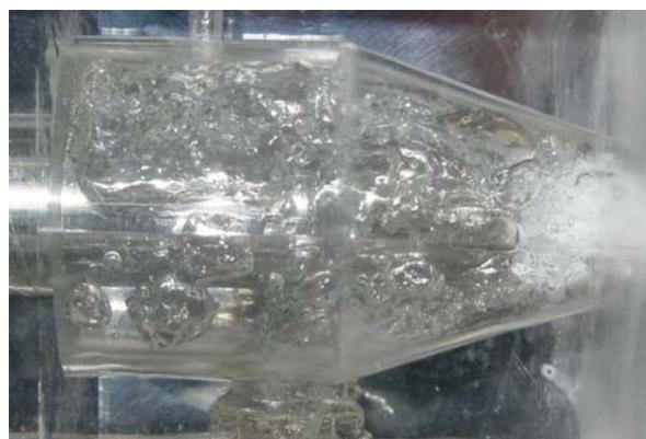
Gambar 11 Pengujian pada tekanan statik kompresor ( $p_c$ ) =  $4 \text{ kg/cm}^2$
