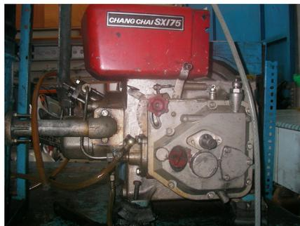
Gambar 2. Motor Bakar yang digunakan "Diesel Type Changchai SX 175".
