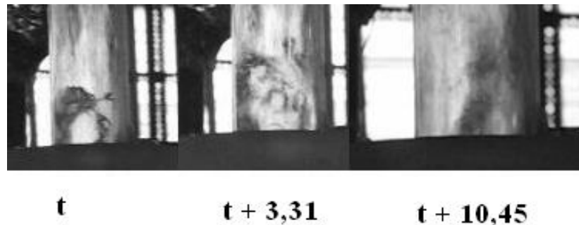
Gambar 9. Fenomena flooding yang terjadi pada obstruksi berbentuk Ring melingkar penuh ( 360^\circ ) dalam satuan waktu detik.
