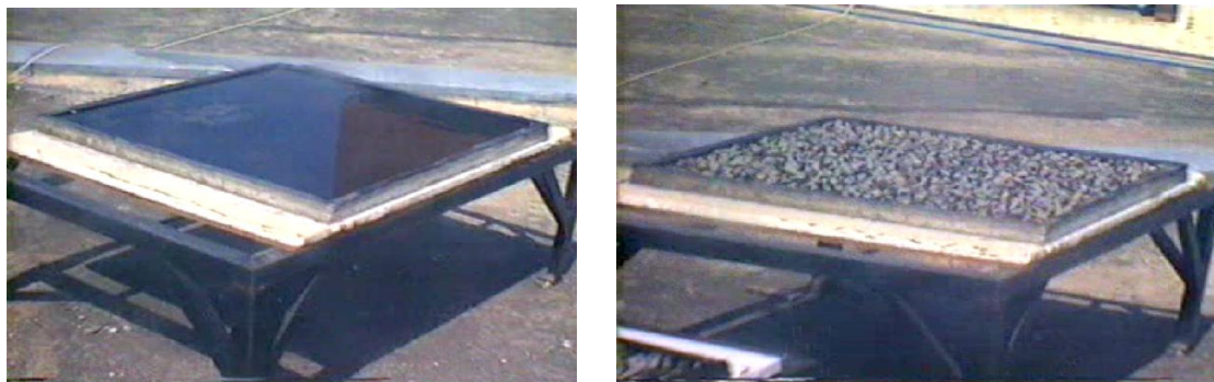
(a) (b) Gambar 2. Pelat penyerap tanpa tambahan batu kerikil (a), dan Pelat penyerap dengan tambahan batu kerikil (b)
