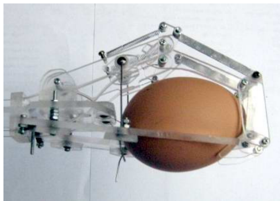
Gambar 7. Pengujian model Pencengkeram Telur Biomekanik
