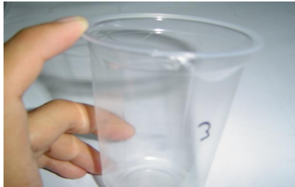
Gambar 10. Jenis cacat cacat menempel dengan cup lain
