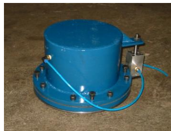
Gambar 5. Prototipe pegas udara yang sudah dihasilkan
